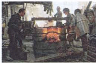
Gußwerkstatt im Sitterwerk: nach dem aufwendigen Prozeß des Wachsau-schmelzverfahrens verlangt der Guß der flüssigen Bronze höchste Konzentration (Foto Katalin Deér)
